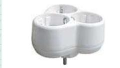
Разветвитель электрический «UNiVersal» на 3 гнезда с заземлением, круглый, белый, предназначен для одновременного присоединения нескольких приборов к одной розетке. Напряжение в сети 220-250 В, частота тока 50 Гц, номинальный ток 16 А, материал корпуса ударопрочный АБС-пластик.
