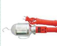
Светильник переносной «UNiVersal» провод марки ПВС (2-0,75) со степенью защиты IP20, с выключателем предназначен для временного местного освещения рабочей зоны при удалении от источника света и питающей сети. Тип источника света лампа накаливания или энергосберегающая лампа; тип цоколь E27, максимальная мощность 60 Вт.
