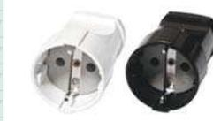
Штепсельное гнездо «UNiVersal» с заземлением предназначено для изготовления или ремонта сетевых удлинителей. Розетка в штепсельном гнезде надежно удерживает вилки российского и европейского стандарта с диаметром штыря 4,0 и 4,8 мм. Напряжение в сети 220-250 В, частота тока 50 Гц, номинальный ток 16 А, материал ударопрочный АБС-пластик белого цвета.
