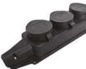
Колодка «UNiVersal» электрическая, в каучуковом корпусе, с заземлением. Соответствует ГОСТ. Имеет повышенную влагозащиту (IP44), может использоваться при отрицательной температуре окружающей среды. Напряжение в сети 220-250 В, частота тока 50 Гц, максимальная мощность 3500 Вт, номинальный ток 16 А. Материал корпуса: каучук. Упаковка: пакет с подвесом.
