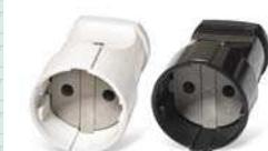
Штепсельное гнездо «UNiVersal» без заземления предназначено для изготовления или ремонта сетевых удлинителей. Розетка в штепсельном гнезде надежно удерживает вилки российского и европейского стандарта с диаметром штыря 4,0 и 4,8 мм. Напряжение в сети 220-250 В, частота тока 50 Гц, номинальный ток 10 А, материал ударопрочный АБС-пластик белого цвета.
