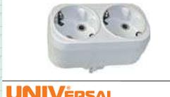
Разветвитель электрический «UNiVersal» на 2 гнезда с заземлением, плоский, белый, предназначен для одновременного присоединения нескольких приборов к одной розетке. Напряжение в сети 220-250 В, частота тока 50 Гц, номинальный ток 16 А, материал корпуса ударопрочный АБС-пластик.
