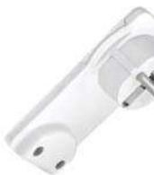
Вилка «UNiVersal» электрическая «невидимка», с выключателем и заземлением 16 А, 250 В, предназначена для подсоединения штепсельных соединений, размер кабеля с номинальным сечением жил от 0,5 до 2,5 мм<sup>2</sup>. Применяется для замены вышедшей из строя или поврежденной неразборной вилки. Уникальная конструкция позволяет использовать розетку и при этом устанавливать мебель рядом с этой розеткой с минимальным зазором от стены.
