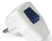
Вилка «UNiVersal» электрическая угловая, с выключателем и заземлением 16 А, 250 В, предназначена для подсоединения штепсельных соединений, размер кабеля с номинальным сечением жил от 0,5 до 2,5 мм<sup>2</sup>. Применяется для замены вышедшей из строя или поврежденной неразборной вилки. Выключатель используется для прекращения подачи электрического тока без разъединения штепсельного соединения.
